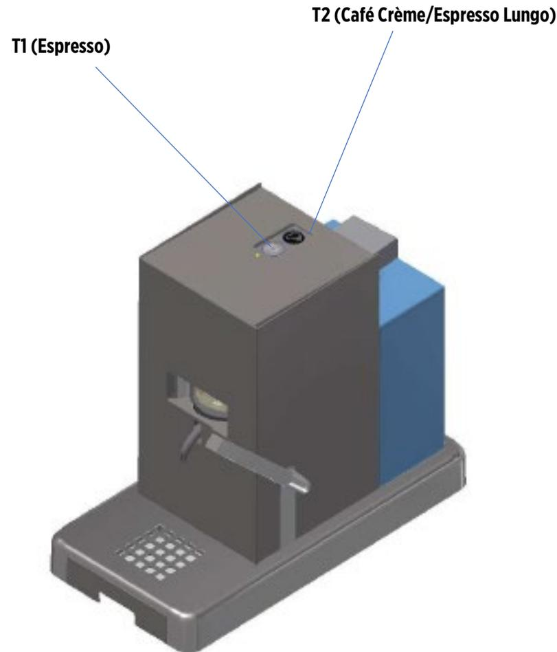
**Um die Maschine einzuschalten**, zuerst die Taste T1 oder T2 drücken (aktiviert die Stromversorgung des Gerätes), Tassensymbole T1 und T2 blinken, Gerät heizt auf (ca. 45/50 Sekunden)
