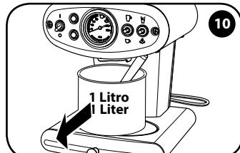
Den Behälter entfernen und entleeren.
